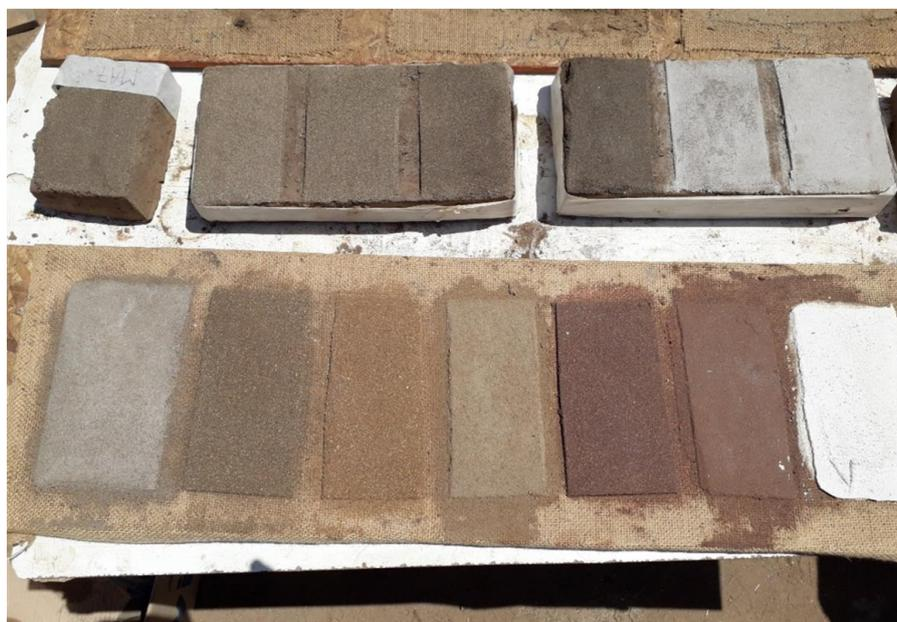
Figura 5: Testes de cimento alternativo feito com a terra da comuna de Lo Zárate durante o projeto *Una Escuela Sustentable* (2020). Fonte: Acervo do/as autores/as.
