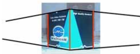
Caixa c/2 pontos de fuga
